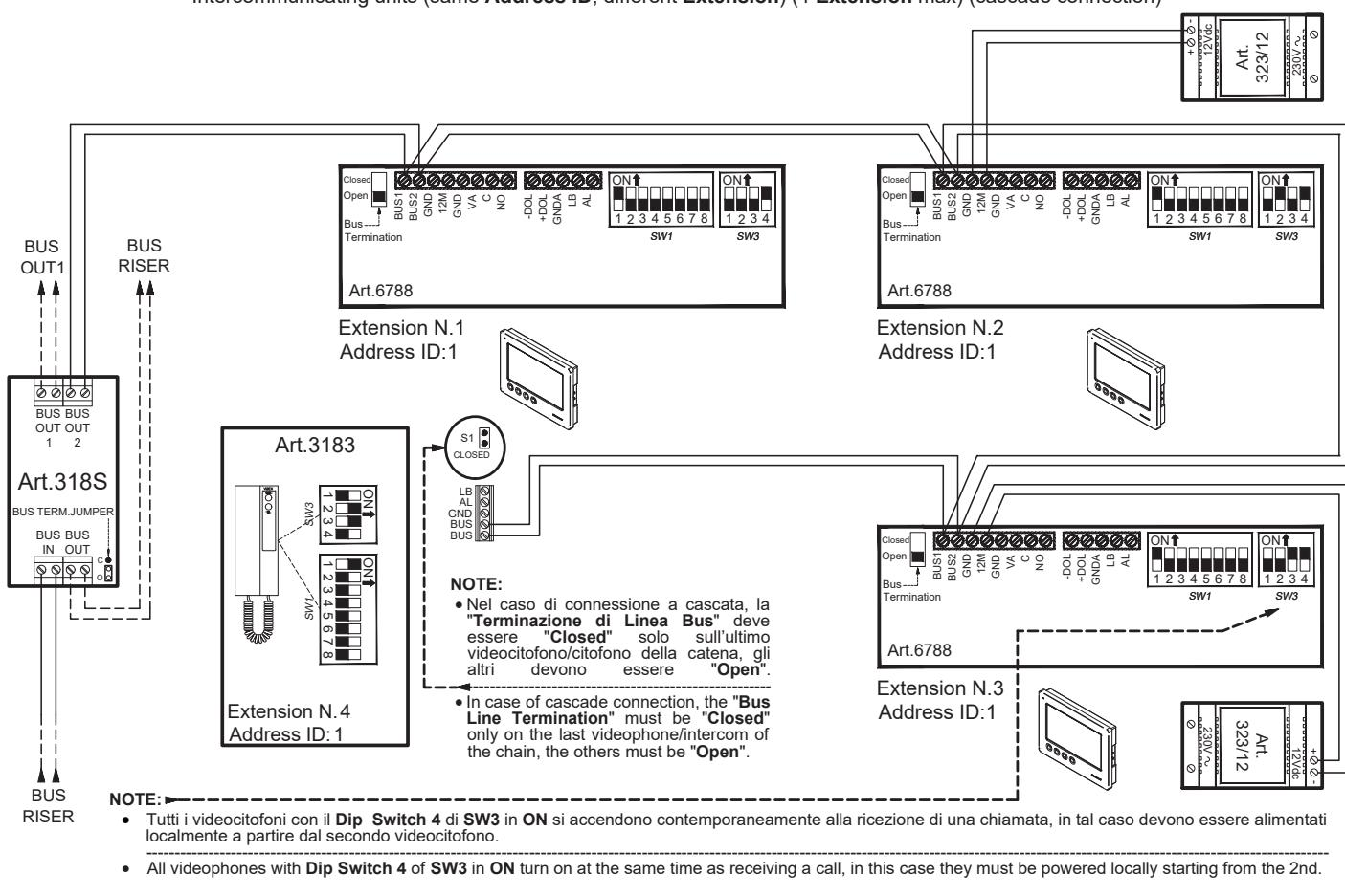
Unità intercomunicanti (stesso indirizzo ID, interni diversi) (4 interni max) (connessione tramite distributore video attivo a 4 vie)
