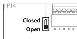
Déplacer l'interrupteur **I** vers le bas pour permettre la terminaison (position **Open**)
