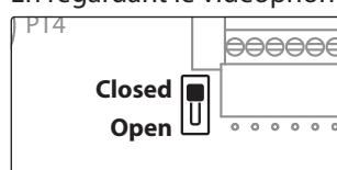
Déplacer l'interrupteur **I** vers le haut pour permettre la terminaison (position **Closed**, réglage d'usine)
