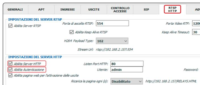
Fig. 11 Abilitare l'Autenticazione tramite software IPure Wizard
