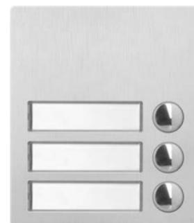
Cartellino portanomi retroilluminato a LED blu, acciaio satinato AISI316, antivandalico (IK07), connettore IDC per collegamento tramite cavo flat con altri moduli opzionali. Temperatura di esercizio -20°/+60°.
